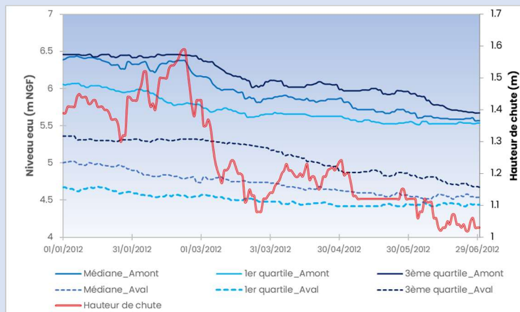
Figure 102 : Evolution des niveaux d'eau de part et d'autre d'un ouvrage en marais ainsi que de la hauteur de chute sur la période hivernale et printanière (données ECOGEA).
