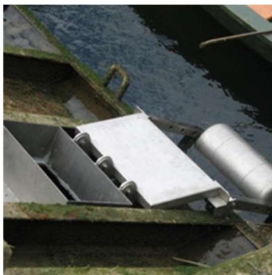
Photo 44 : Dispositif mixte avec flotteurs pour retarder la fermeture et ouverture au-dessus.
