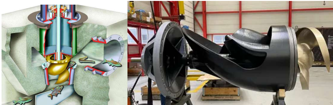
Photos 87 et 88 : Illustrations de deux types de pompes classées comme ichtyocompatibles (© Bosman Water management ; Flowserve)
