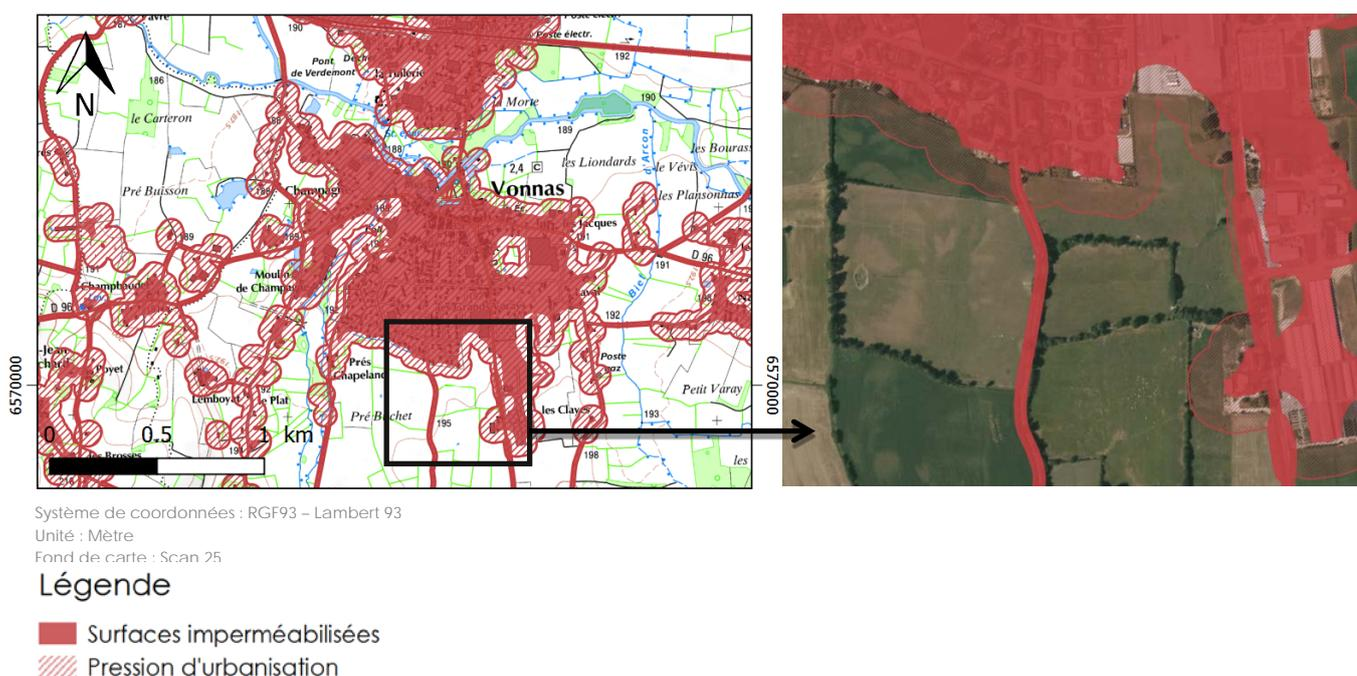
Figure 14 : Carte des surfaces imperméabilisées et pression de l'urbanisation à Vonnas, associée à une prise de vue aérienne
