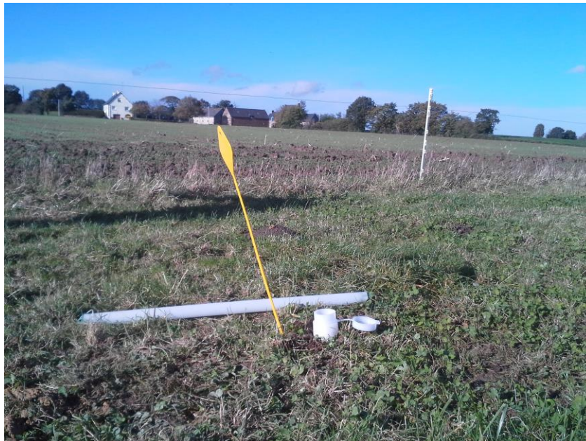
Piezomètre: tube PVC percé
