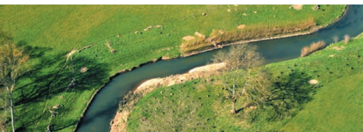
La Petite Veyle reméandrée en avril 2009. Les premières érosions de berges apparaissent.
