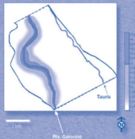
Modélisation de la variation piézométrique maximum au niveau d'une zone humide alluviale de la Garonne (site de Monbéqui, variations exprimées en mètre) durant une crue (Weng et coll., 2003).
